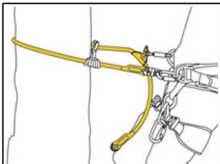
Conçue pour être utilisée à double sur les points d'attache latéraux du harnais.
