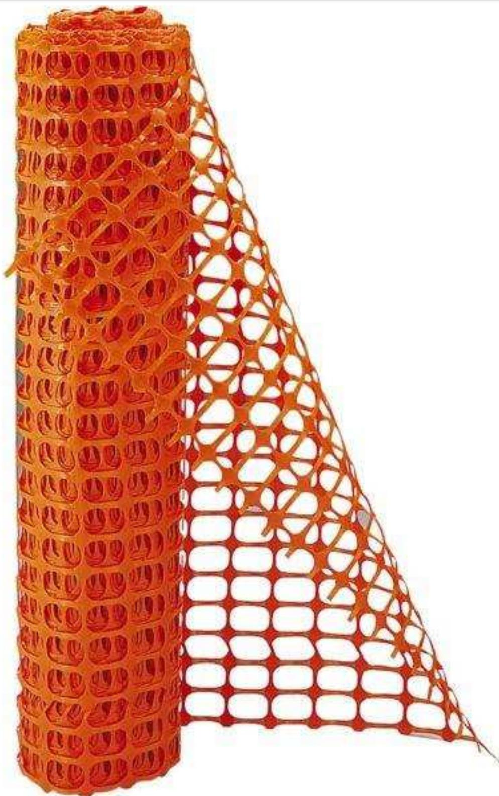
**SIGN\_FILET\_PVC** (Réf. **13111**) **Filet barrière de signalisation** ■ Protection de chantier en polypropylène haute densité. Très résistante à la traction, traitée anti-U.V. Coloris : orange. Dimensions : 1 x 50 m. Poids : 140 g/m<sup>2</sup>.
