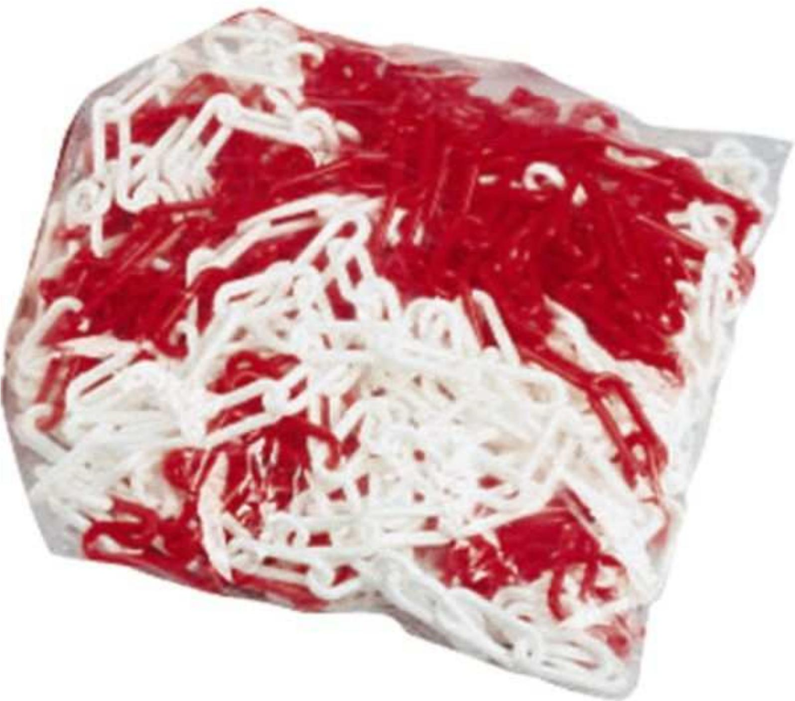
**SIGN\_CHAINE** (Réf. **14426**) Chaîne de signalisation rouge/blanche ■ Polyéthylène haute densité, stable aux UV ■ Bonne résistance mécanique ■ Sac de 25 m ■ Cotes extérieures des maillons Ø 8 mm : 70 X 27 X 8 mm.
