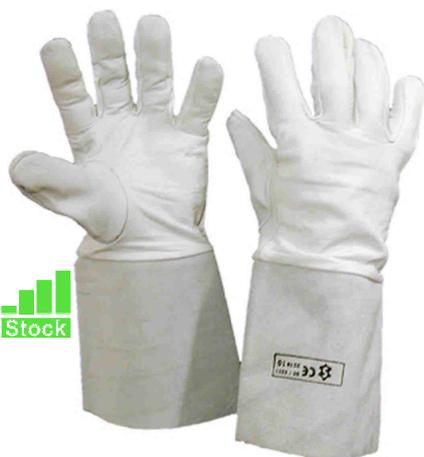
**GANT HT15 KEVLAR (M.13514)** Gant HT15 coutures KEVLAR de manutention pour soudeur ■ **Spécificités** : Bonne résistance à la flamme, à la chaleur de contact ( 100°C pendant 15 secondes ), convective et radiante ■ **Composition** : Cuir croûte de bovin traité anti-chaleur avec manchette de 14cm doublure intérieure en coton sur la paume et le dos, coutures KEVLAR ■ **Tailles** : unique ■ **Cdt.** : par 10 paires ■ **Normes** : EN388 3.1.3.3 EN407 4.1.3.x.4.x EN12477:2001 + A1
