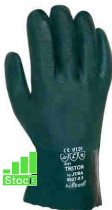
**GANT\_PVC\_36SUP** (M. 11727) Gant PVC 36 double couche pour manutention produits chimiques ■ **Spécificités** : finition lisse et traitement **SANITIZED** anti-bactériologique ■ Montage coupé/cousu avec enduction ■ **Composition** : enduction PVC rouge longueur 36 cm tout enduit sur support coton épaisseur 1.10 mm , paume finition lisse ■ **Tailles** : T9- T10 ■ **Cdt.** : par 10 paires ■ **Normes** : EN388 4.1.2.1 X - EN374-1 A.K.L EN374-5 VIRUS ■
