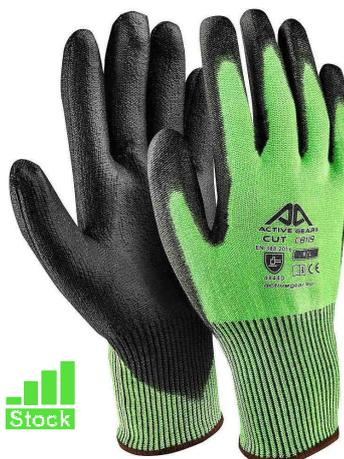
**GANT\_ACTIV\_C8120** Gant ACTIVE CUT anti-coupeures, écran tactile, niveau D enduit PU pour manipulation de produits coupants ■ **Spécificités** : anti-coupeures, compatible écran tactile, bonne dextérité **sans fibre de verre** ■ **Composition** : composé de nylon/fibre haute ténacité HPPE./Spandex vert jauge 13 et enduction polyuréthane noir sur la paume et bouts des doigts ■ **Tailles** : T6 à T11 ■ **Conditionnement** : par 12 paires ■ **Normes** : EN388 4.X.4.3 D
