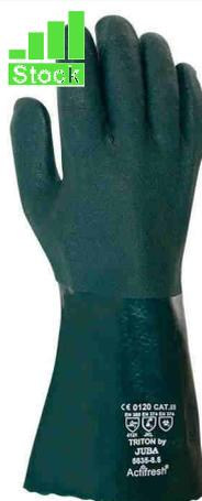
**GANT\_PVC\_36DE** (M. 11924) Gant PVC 36 Double Enduction pour manutention produits chimiques ■ **Spécificités** : finition antidérapante et traitement **Sanitized** anti-bactériologique ■ **Composition** : enduction PVC vert double enduction longueur 36 cm tout enduit sur support coton gratté, paume finition rugueuse ■ **Tailles** : T9 (L) et T10(XL) ■ **Cdt.** : par 12 paires ■ **Normes** : EN388:2016 4.1.2.1 X - EN374-1:2016 type A J.K.L.M.P.S.T EN374-5:2016 VIRUS ■
