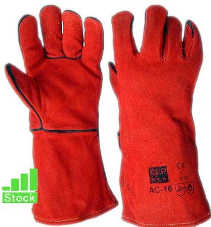
**GANT HT15** Gant HT15 de manutention pour soudeur ■ **Spécificités** : Bonne résistance à la flamme, à la chaleur de contact, convective et radiante ■ **Composition** : Cuir croûte de bovin traité anti-chaleur avec manchette de 14cm doublé toile et bord ourlé ■ **Tailles** : unique ■ **Cdt.** : par 12 paires ■ **Normes** : EN388 3.2.3.3 EN407 4.1.3.x.4.x EN12477 Type A
