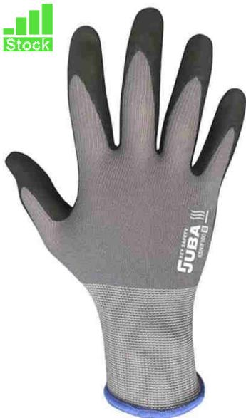
**GANT\_KSNIF100** Gant nylon/spandex KSNIF100 enduit mousse nitrile paume, jauge 15 ■ **Spécificités** : Léger et souple, bonne respirabilité, dextérité exceptionnelle, bonne adhérence sur les surfaces sèches, humides ou huilees ■ **Composition** : En nylon et **Spandex** enduit de nitrile microporeux sur la paume **jauge 15** ■ **Tailles** : 6 à 11 ■ **Conditionnement** : par 10 paires ■ **Normes** : EN388 4131A - EN407 X1XXXX
